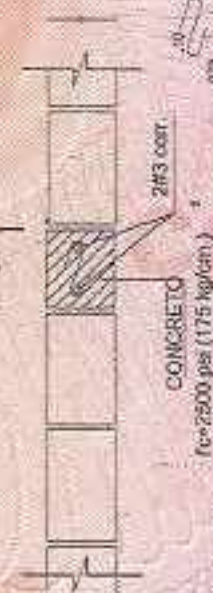
REFUERZO COLUMNETA CTM VISTA EN PLANTA ESC: 1/10
